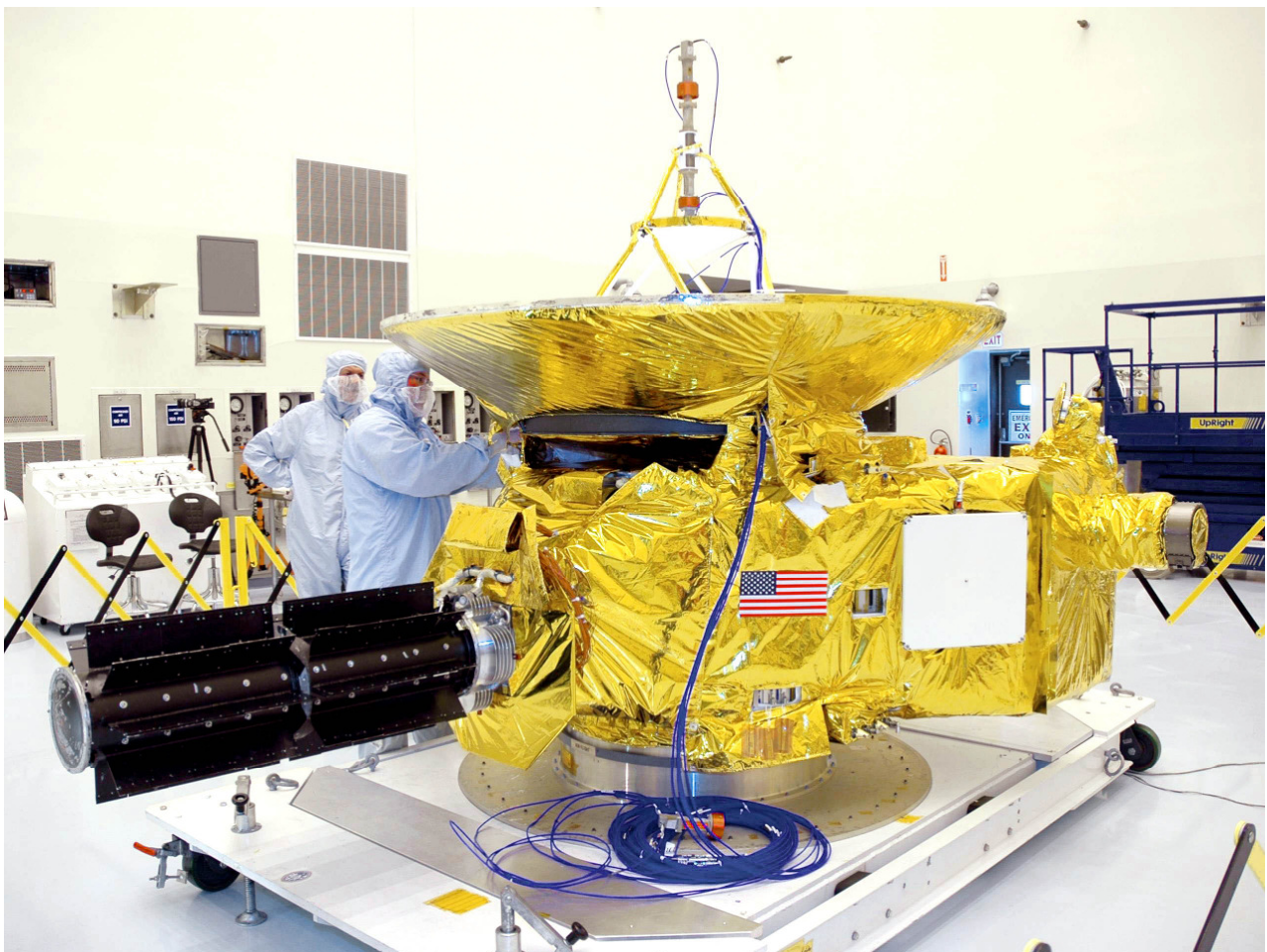
Die Endmontage von New Horizons, links der RTG (schwarz)
