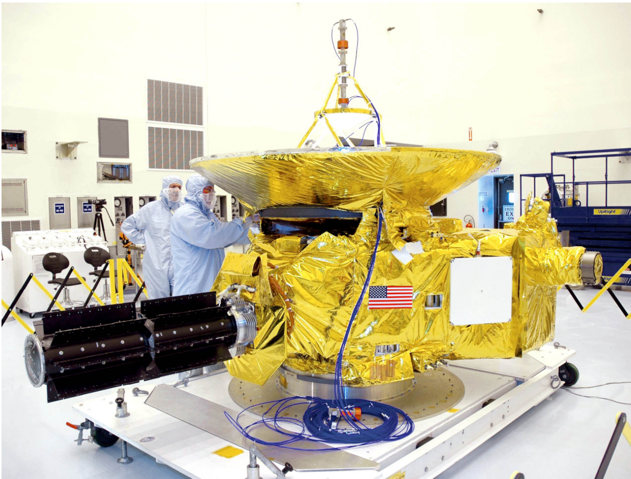
New Horizons eingepackt in Goldfolie, links der RTG
