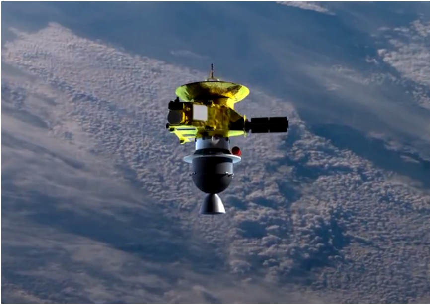
Die Sonde in Erdnähe, deutlich zu erkennen: Das STAR 48B-Triebwerk am Heck
